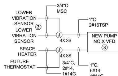
**EFFLUENT PUMP NO.X CONTROL RISER**
