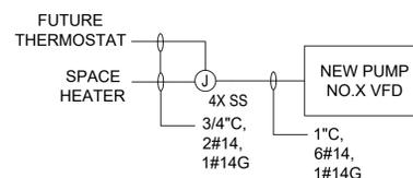
**EFFLUENT PUMP NO.X CONTROL RISER**
